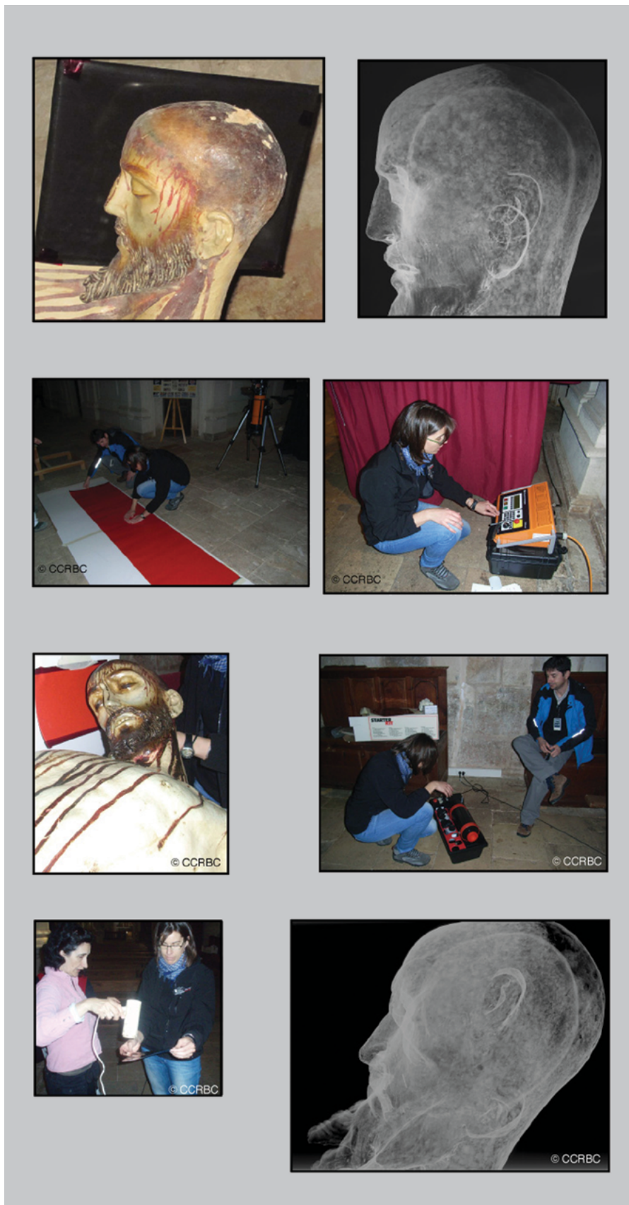
FIGURA 3. Cristo crucificado de Lerma, prueba radiográfica de cabeza con película médica, proceso de radiografiado y resultado con película de rollo continuo (Cortesía: Archivo del CCRBC-JCYL e IPCE, 2011).
